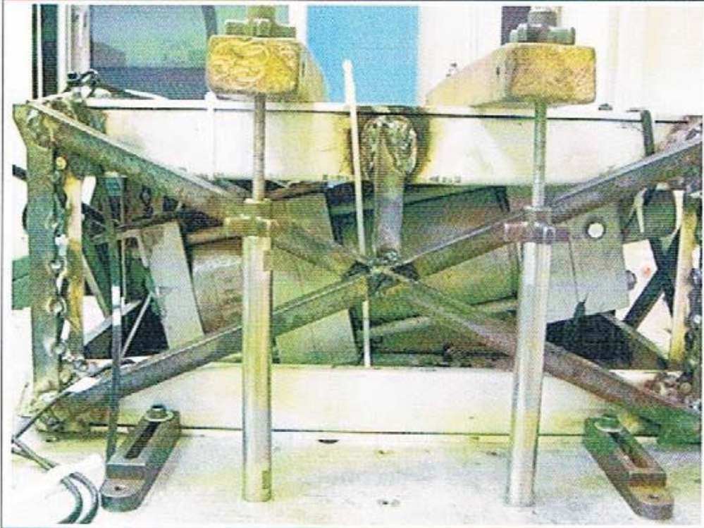
測試條件2-Z 軸 55 小時 (汽缸左側懸掛螺絲斷裂導致汽缸脫落)
