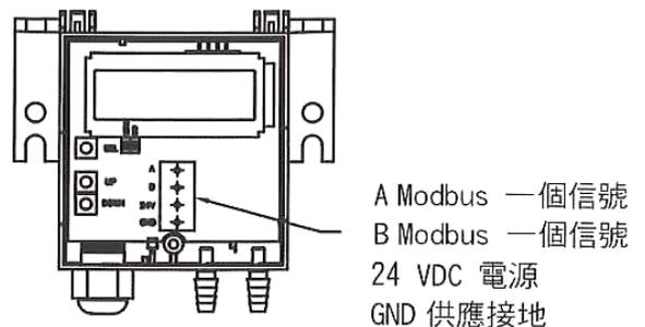
零點調整注意: 電源電壓連接一小時後再進行零點調整
