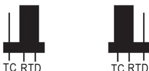
硬體部分: 拔出儀錶, 在儀錶主板上插針選擇熱電偶或熱電阻
