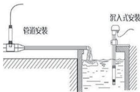
**沉入式安裝：**感測頭的引線從不銹鋼管穿出，感測頭頂部的3/4 螺紋與不銹鋼3/4螺紋用生料帶相連接。確保電極頂部及電極線不進水。
